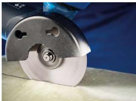
Благодаря большим пространствам для стружки алмазные шлифовально-отрезные круги на гальванической связке характеризуются высокой режущей способностью.
